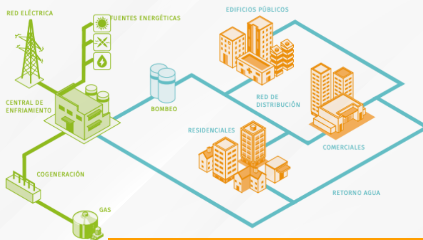
Componentes de los distritos térmicos, esquema general
